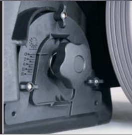
Einfaches, werkzeugloses Einstellen und Wechseln der Hauptkehrwalze.
